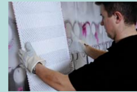
4. Prüfung der Platten auf Haarrisse und Kontaktkorrosion
