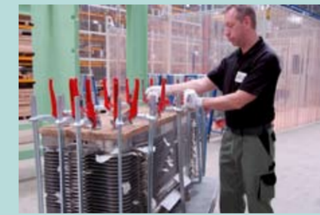
9. Spannung des Plattenpakets und anschließend beschleunigte Aushärtung des Klebstoffs mittels Wärmebehandlung
